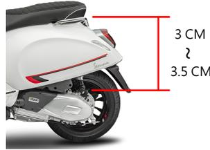
避震器安裝上車後量測基準點到
