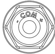
當避震器在壓縮行程時，若是覺得避震器壓縮太快或太軟，可以試著將旋鈕順時鐘旋轉，將壓側阻尼調強，直到覺得避震器在壓縮時，有點太硬或是騎起來有點顛簸時，再將旋鈕逆時鐘旋轉1-2格放弱阻尼直到舒適度足夠即可。
